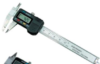
**Штангенциркуль** является самым распространенным измерительным прибором. Это инструмент, который состоит из негнущейся металлической линейки, именуемой штанга, рамки с нониусом и измерительных губок. На штанге есть разметка с ценой деления от 0,5 мм, а цена деления нониуса – 0,01 мм. Со штангенциркулем очень просто работать. Используется во всех отраслях техники.
