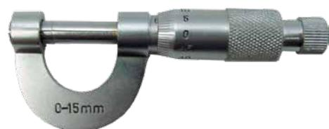
**В 212511** Микрометр, 0–15 мм
