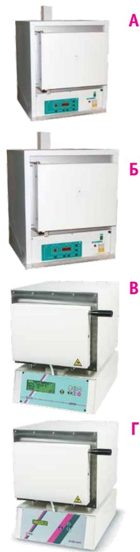
Муфельная печь от компании **Sirio Dental (Италия)**, предназначена для выпаривания воска, предварительного прогрева и прокаливания запечатанных ювелирных изделий. Температура в печи измеряется термоэлементом и контролируется с помощью микропроцессора. Выгорание воска и предварительный прогрев муфтелей с запечатанными моделями коронок, мостов и бюгельных протезов осуществляется при температуре до 1100°C. Корпус из нержавеющей стали. Гарантия 1 года.
